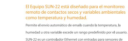
temperatura y humedad, y entradas para detectores de inundación, humo, apertura de puertas, corte eléctrico entre otros. SUN-22 posee una salida de Relay, que puede ser activada por IP.
