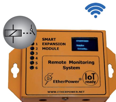
✓ Este módulo SEM le agrega a la solución EtherpowerBox la posibilidad de accionar **2 Relays de forma remota**.
